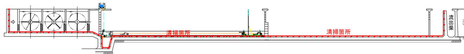
沈殿池断面図 S=1/350
