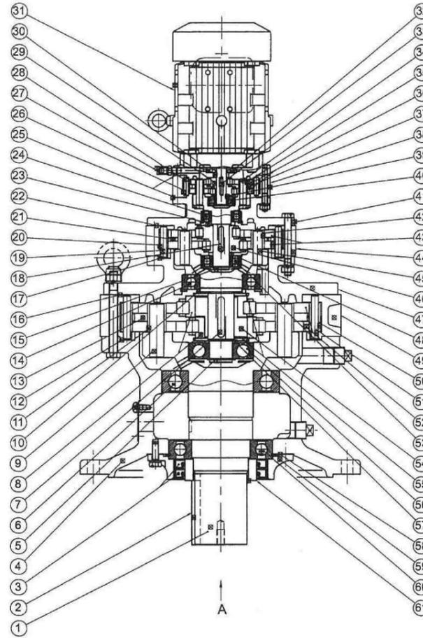
図 83 CVVM 形(立形・ギヤモータ)、3 段形
