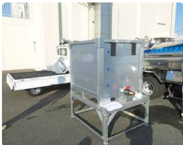
組み立てた非常用給水タンク
